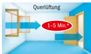
Fenster und gegenüberliegende Tür/Fenster sind ganz offen.
